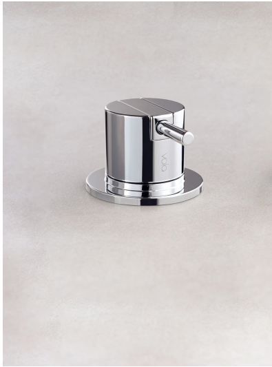
500 Monoknop bladmengkraan met keramisch cartouche. Kraangat 42 mm. Aansluiting: 3/8" (flexibele slangen).
