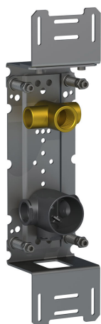
4300 Elektronische inbouwtapkraan voor handvrije bediening, verticale montage, zonder mengfunctie. ½" aansluiting. Standaard geleverd met batterijen. Gebruik via netspanning mogelijk, dan adapter apart bestellen. Inclusief elektronische box VR2617.
